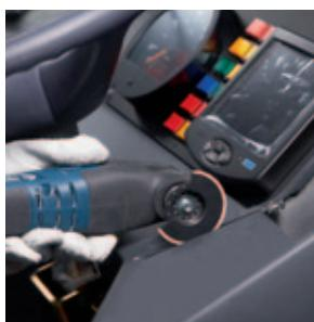
HM-RIFF listovi za tanki rez odlično su prikladni za sečenje/glodanje abrazivnih delova automobila ili čamaca, npr. isečci u armaturnoj ploči.
