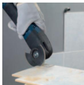
Precizno sečenje manjih isečaka u mekim zidnim pločicama.
