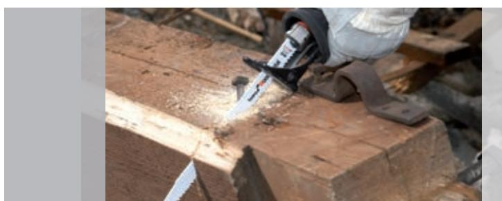
Sa novim listovima univerzalne testere Heavy for Wood and Metal presečete na gradilištu jednostavno sve što vam se nađe na putu: drvo sa ekserima, profili okvira od drveta sa metalom, plastične cevi i profili. Idealna za radove rušenja.
