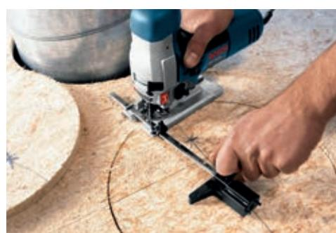
Sa listom Progressor for Wood and Metal T 345 XF lako presečete drvo sa ekserima na gradilištu, ali i limove, cevi i aluminijumske profile.
