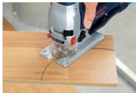
List ubodne testere T 101 BIF Special for Laminate idealan je za obostrano precizno, čisto sečenje u laminatu i pločama obloženim plastikom.
