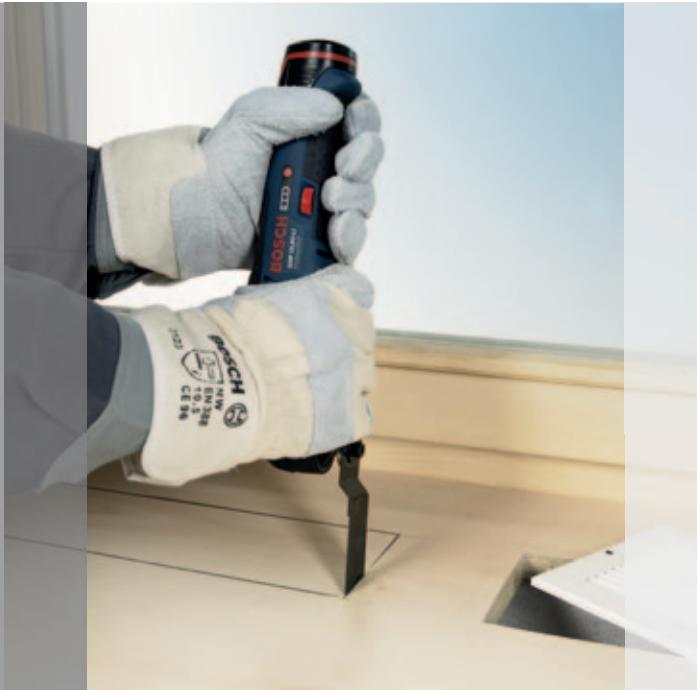
Sa Bosch priborima za Multi-Cutter donosi se preciznost sve do najzavučenijeg ugla. Jer pribor omogućava da se i na najužem prostoru – čak i blizu poda i zida – ostvari tačan rez. Listovi testere izrađeni od bimetala i tvrdog metala ne zaustavljaju se ni pred metalom.
