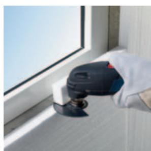
Sečenje izolacionog materijala, npr. stiropora, po dužini u ravni sa površinom.
