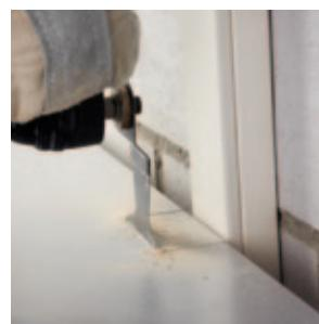
Precizno zasecanje uranjanjem u obložene ploče, npr. iseći za policu.
