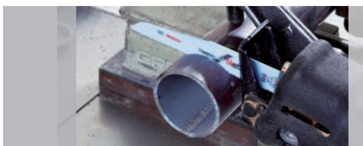
Kontrolisano snažno sečenje. List Heavy for Metal S 920 CF nudi vam sečenje pod tačnim uglom ne samo pri radovima sa metalom nego i kod sečenja teških profila. Ima veoma male vibracije i idealan je za primenu u alatu za sečenje cevi.
