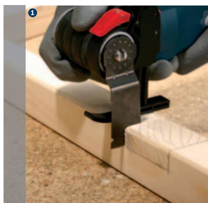
Precizno zasecanje uranjanjem u drvetu, npr. za rezove u konstrukciono drvo
