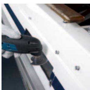
Sečenje epoksija i fiber-stakla moguće je i sa novim dijamantskim listom; najduži vek trajanja, npr. rešetka za ventilaciju u trupu čamca.
