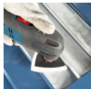
Brušenje, pripremanje i poliranje laka sa setovima brusnih listova i kladicama za poliranje.
